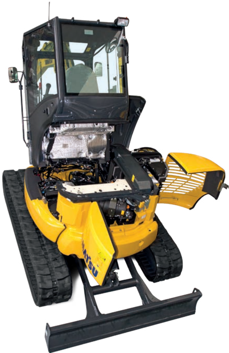
Bakhuvar för snabba motorinspektioner, enkla kontroller, kylarrensning och enkel åtkomst till batteriet
